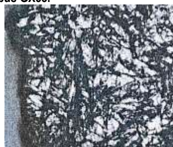
Поверхностный слой с измененной структурой x500. Глубина 0.12...0.14 мм
