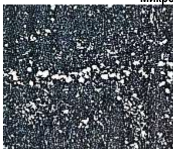
Структура сердцевины образца x500 Карбидная неоднородность, балл 4
